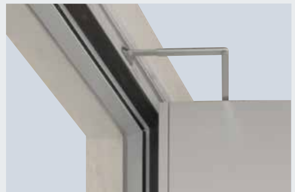
Standardkarm 140 / 75 mm, 3-delt med omsluttende tætningsnot på 3 sider
