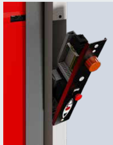
Servicevenlig åbning af den integrerede styring
