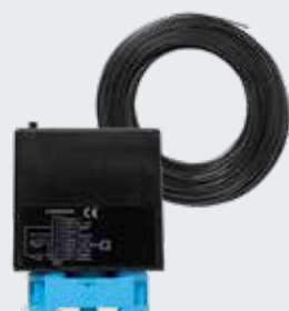
Induktionssøjle Detektor med lukker og veksler, kan indstilles til impulskontakt eller vedvarende kontakt, retningsregistrerende, 50 m sløjfekabel
