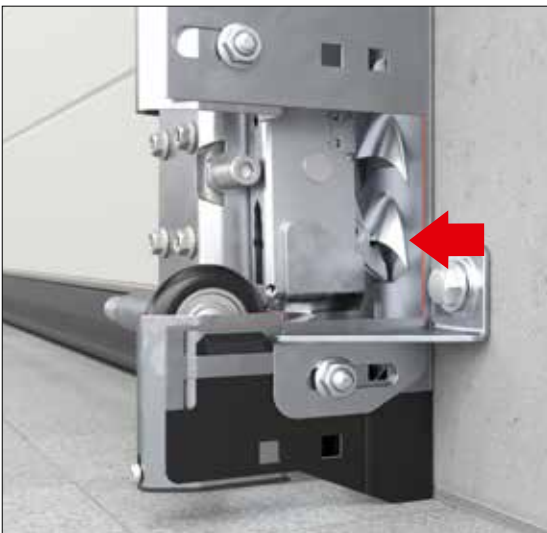
Låsekrogen på løftesikringen falder automatisk sikkert i hak, hvis porten løftes.
