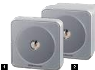
Nøglekontakt STUP 50 1 STAP 50 2 Indbygning i væg eller montering på væg, inkl. 3 nøgler, zink trykstøbt kabiner i hvidaluminium RAL 9006 med afdækning af rustfrit stål
