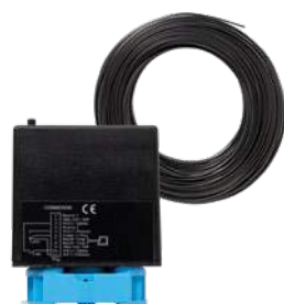
Induktionssløjfe Induktionssløjfedetektor med lukker og veksler, kan indstilles til impulskontakt eller vedvarende kontakt, retningsregistrerende, 50 m sløjfekabel
